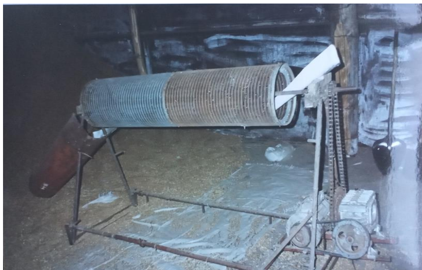
Рис. 1. Изготовленное фермером В.Н. Кузекеевым зерноочистительное устройство для очистки зерна пшеницы от семян сорняков
