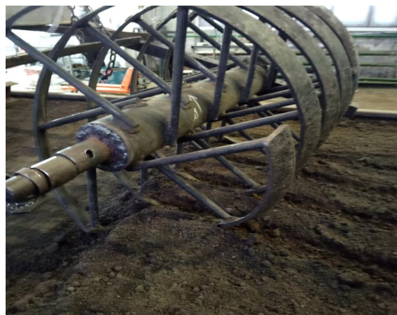
Рис. 2. Экспериментальный образец винтового катка, изготовленный для лабораторных исследований в почвенном канале
